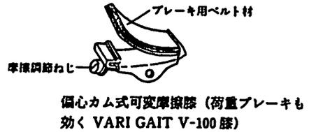
図 11-6 可変摩擦膝継手の一例
